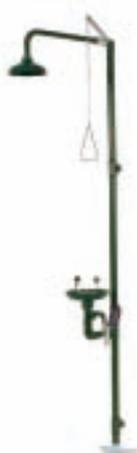
**ISC700** - Doccia "DILUVIO®" combinata con lavaocchi, con soffione in polipropilene completo di valvola a chiusura manuale con azionamento a mezzo tirante rigido con comando a triangolo. Lavaocchi a flusso aerato completo di valvola a chiusura manuale con apertura a mezzo di push laterale e vaschetta in polipropilene. Versione tutta in acciaio inox **ISC700X**
