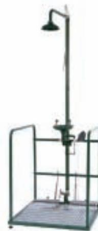
**ISC730** - Combinazione "DILUVIO®" composta da doccia con soffione gigante in polipropilene, valvola a chiusura manuale a mezzo tirante rigido, con impugnatura a triangolo; lavaocchi a flusso aerato con valvola azionata a mezzo pedana e push laterale, bacinella in polipropilene. Completo corrimano perimetrale. Sistema autodrenante, una speciale valvola permette il completo svuotamento dei tubi dopo l'utilizzo, ideale per esterni
