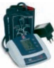
**SFI241** - Sfigmomanometro digitale automatico, validato clinicamente e conforme alle normative EN1060-1 EN1060-3 EMC 89/336/EEC. Display di grandi dimensioni e 90 memorie. Metodo di misurazione: oscillometrico. Range di misurazione 20-280 mmHg, polso 40-180 battiti/minuto. Accuratezza: pressione +/- 3 mmHg, polso +/- 5% della lettura. Autospegnimento dopo 1 minuti di inattività. Alimentazione con 4 batterie stilo AA 1,5 Volt (comprese)
