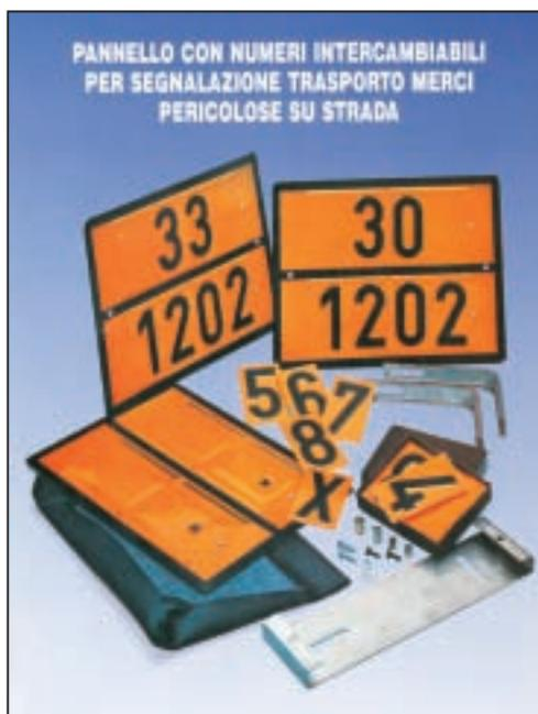
**art. K04** Kit con numeri intercambiabili per prodotti petroliferi completo di pannello con guide, staffa, viti zincate, copripannello e scatola contenente 8 piastrine numeriche per composizione 30/1202 Gasolio, 30/1223 Cherosene, 33/1203 Benzina e tutti gli idrocarburi con un punto di infiammabilità tra 0°-100°C. In acciaio inox AISI 304.
